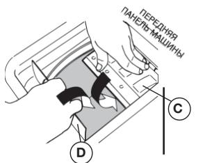
4. Опустить переднюю дверцу **C**, затем заднюю дверцу **D**, чтобы крюк передней дверцы **C** надежно вошел бы в щель. Отпустить обе дверцы.
