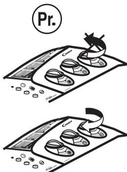
**НИКОГДА НЕ ВРАЩАЙТЕ РЕГУЛЯТОР ПРОТИВ ЧАСОВОЙ СТРЕЛКИ**, а только по часовой стрелке, и не нажимайте на кнопку **ПУСК/СТОП (H)** до установки программы.
