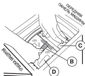
2. Нажать на клапан **B** и не отпуская его нажать на переднюю дверцу **C**, чтобы раскрылись обе дверцы **C** и **D**.
