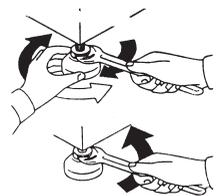
Проверьте нивелировку машины, подталкивая ее без перемещения, последовательно опираясь на края по диагонали в верхней части машины. Убедитесь, что машина не качается.
