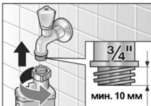
Пластмассовые детали соединения завинчивать только руками. Не вынимайте фильтр из шланга подачи воды.
